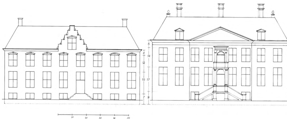
2 Reconstructie van de voor- (links) en van het ontwerp van gevel van het huis van Buysero volgens de aanwijzingen van het bestek van 1640 (rechts) (tekening Pieter Post (auteur)).
